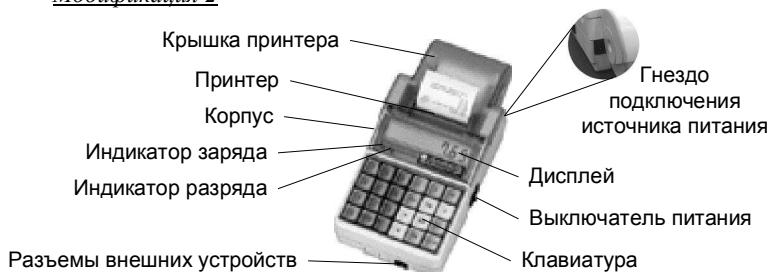
**Рисунок 2 Внешний вид ККТ (модификация 2)**
