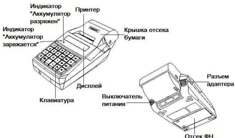
Рисунок 1 Внешний вид ККТ (модификация 1)
